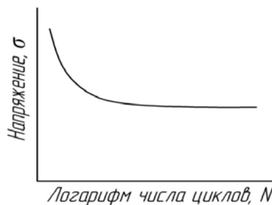
Рисунок 2 – Типичная \sigma - N кривая для стали 35ХНЛ
