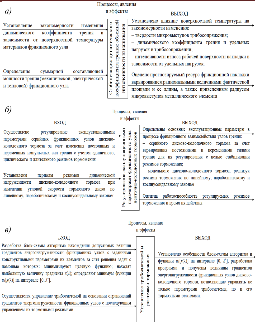
Рисунок 5 а, б, в – Третий, четвертый и пятый уровни робастической методологии, касающейся: а - стабилизации эксплуатационных параметров трибосопряжения; б, в – регулирование и управление эксплуатационными параметрами и тормозными режимами фрикционных узлов дисково-колодочных тормозов
