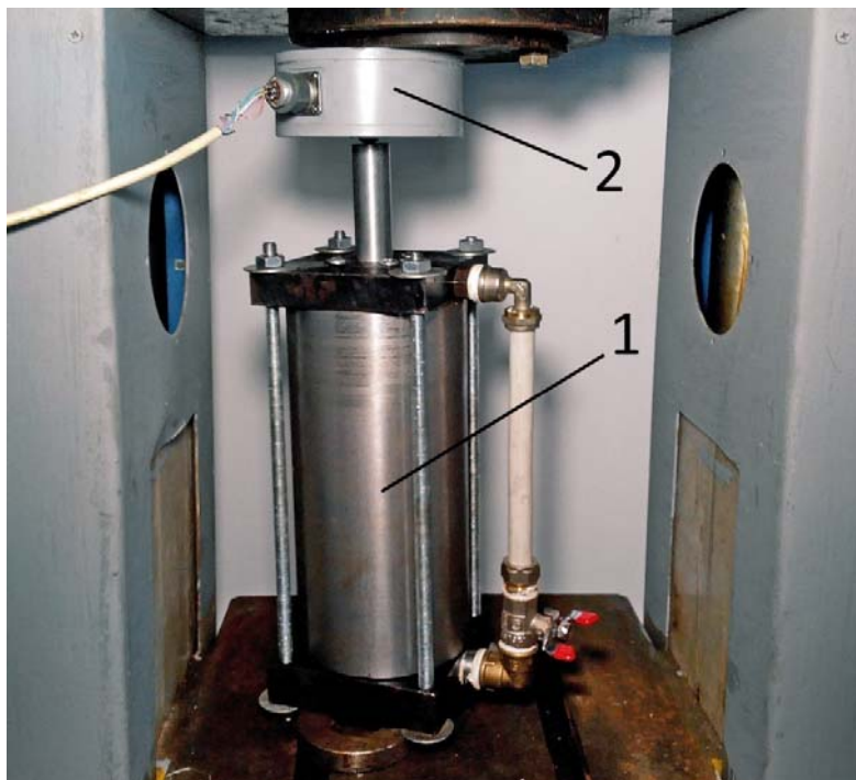
Рисунок – 1.2. Установка пружинно-гидравлического тормоза на прессе (1 – тормоз; 2 – тензометрический датчик).
