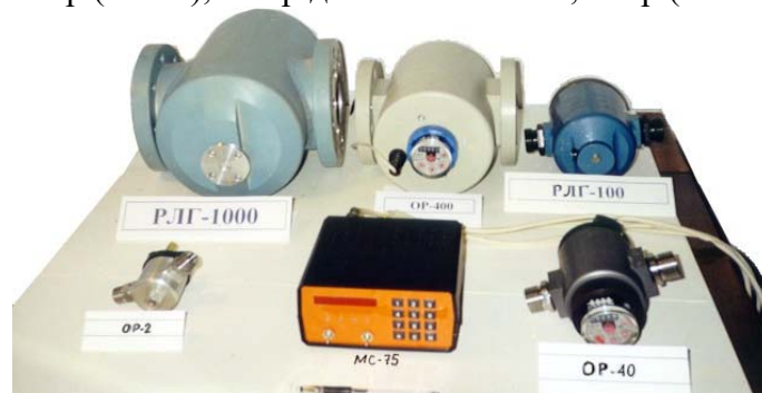
Рисунок 3 - Роликолопатеві витратоміри серій ОП-V 0 і РЛГ-V 0 та вторинний електронний прилад моделі МС-75
