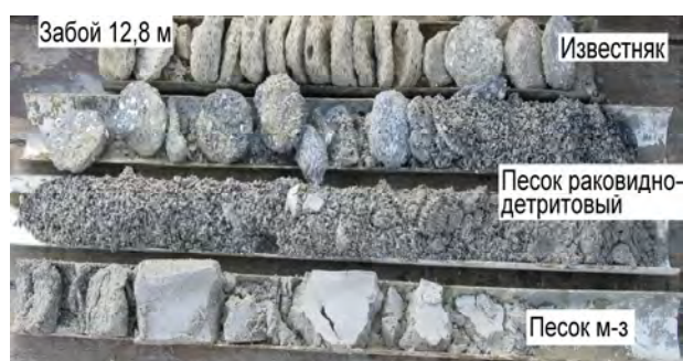
Рис. 5. Общий вид образцов керна при изысканиях под площадки постановки СПБУ «Петр Годованец», Черное море (Украина)
