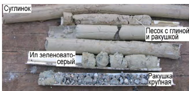
Рис. 5. Общий вид образцов керна при изысканиях под площадки постановки СПБУ «Петр Годованец», Черное море (Украина)
