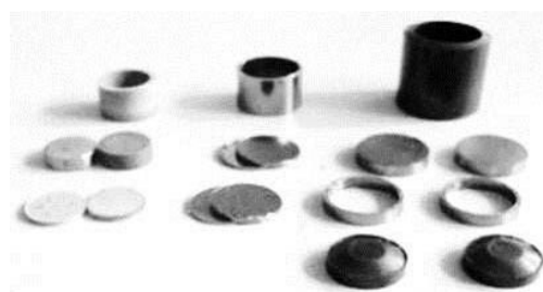
Рис. 1. Схематическое изображение ячейки высокого давления (а) и общий вид деталей сборки (б)
