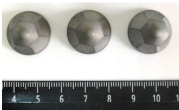
Рис. 3. Внешний вид зубков. Слева по варианту один, в центре и справа по второму варианту, без пластификатора
