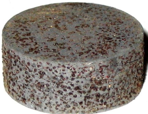
Рис. 1. Выделение пластификатора на поверхности после сушки.
