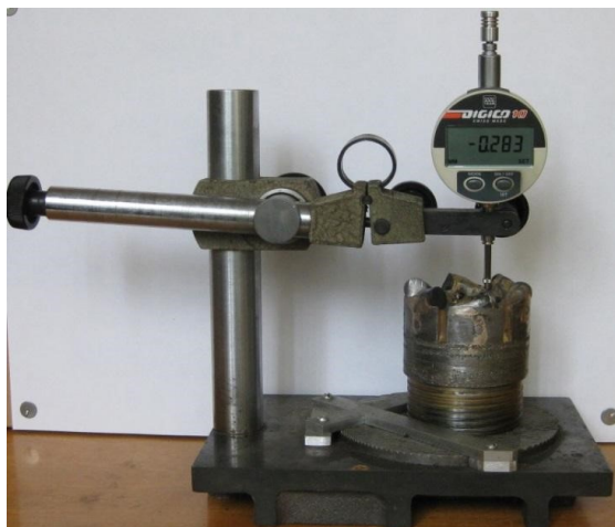
Рис. 3. Общий вид специального приспособления для измерения износа породоразрушающего инструмента по высоте
