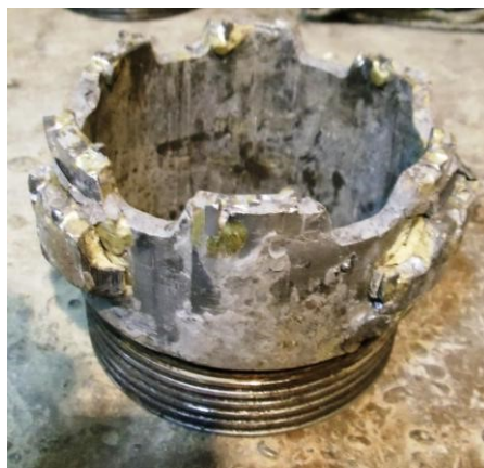
Рис. 1. Коронка типа CM-5 с дополнительными приварными секторами
