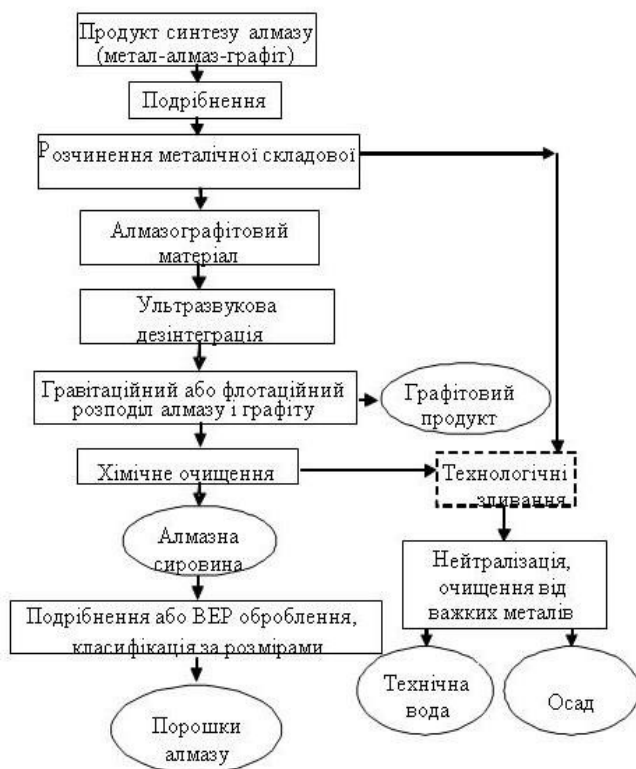
Рис. 2. Принципова схема переробки тонковкрашеного ПС
