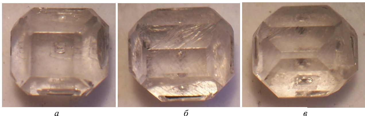
Рис. 3 Образцы выращенных кристаллов массой: а – 0,7 карат; б – 0,8 карат; в – 0,65 карат.
