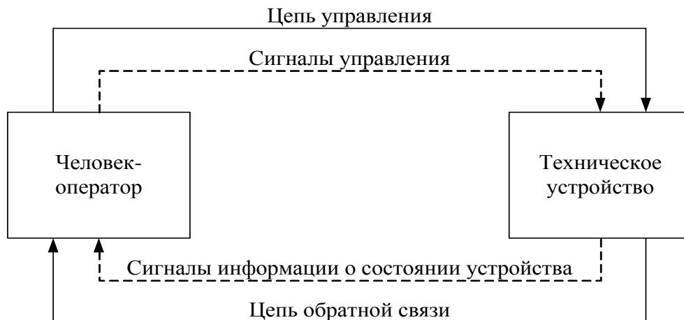
Рис. 2. Структурная схема технической системы управляемой человеком
