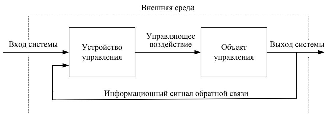
Рис. 1. Общая структура и принцип построения управляющей системы
