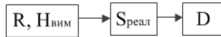
Рис. 9 – Причинно-наслідковий ланцюг дій при проектуванні складових елементів будь-якого рівня СУ на базі готових модулів
