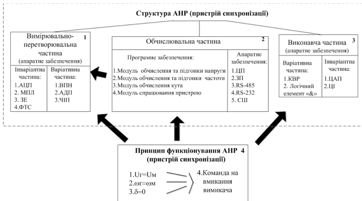
Рис. 6 – Засіб навчання другого кроку другого етапу щодо вивчення реалізації задачі вмикання синхронного генератора на паралельну роботу
