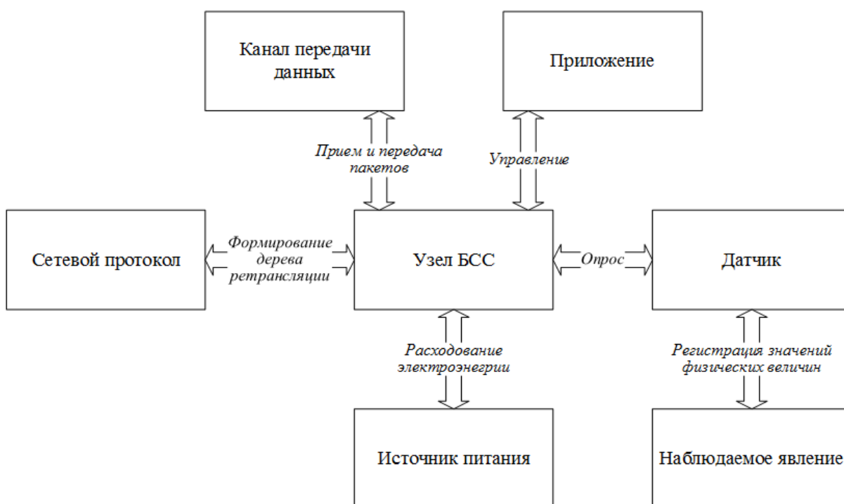
Рисунок 4 – Схема взаимосвязей элементов модели БСС
