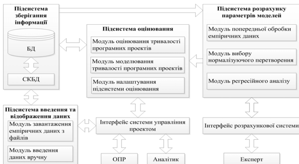
Рисунок 1. Архітектура автоматизованої системи переробки інформації для оцінювання тривалості проектів з розробки програмного забезпечення.
