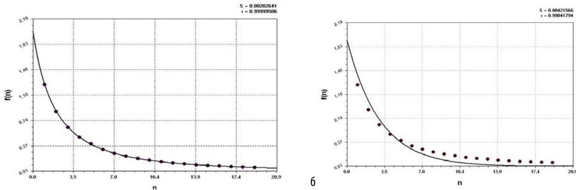
Рис. 3. Аппроксимации переходного процесса, а) степенная функция, б) экспонента.
