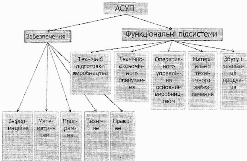
Рис.1. Загальна структурна схема АСУП
