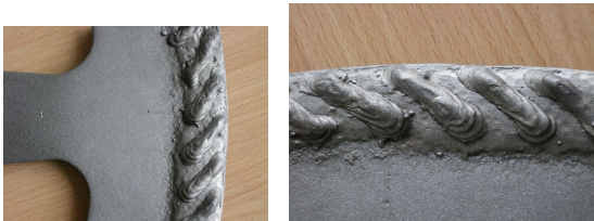
Рис. 7. Дослідний зразок диска копача зі спіроїдним шаром наплавки до експлуатації
