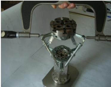
Рис. 7. Виміри фактичної довжини кожної із пружин мікрометром
