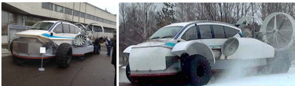
Рис. 4. Экспериментальный прототип «Транспортного средства с воздушной разгрузкой»
