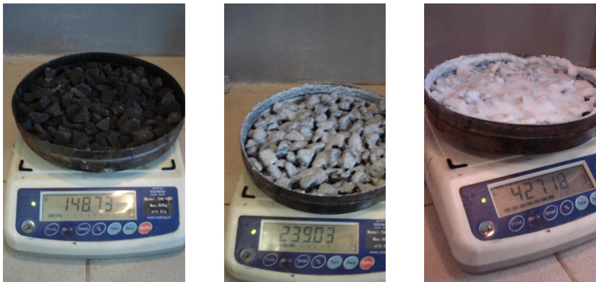
Рис. 6. Вогнегасні системи на основі піноскла для гасіння пожежі класу В: а) гасіння піносклом; б) гасіння піносклом з не суцільним шаром гелю; в) гасіння піносклом з суцільним шаром гелю
