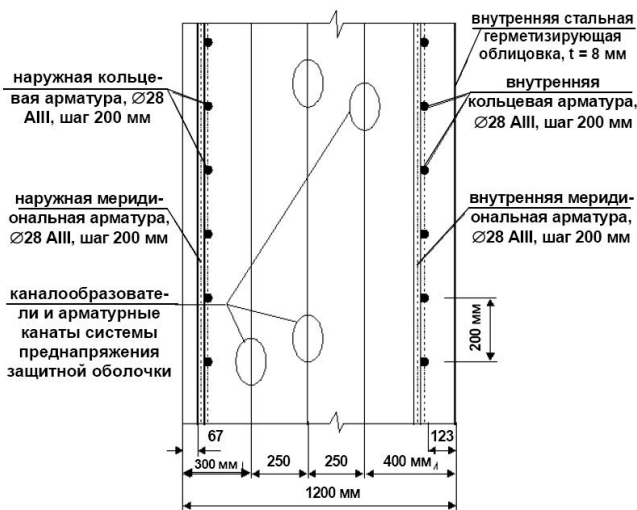
Рис. 5 – Конструкция стенки цилиндрической части 3О
