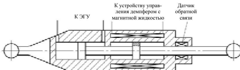
Рис. 3. Гидроцилиндр мехатронного модуля станка с параллельной кинематикой с управлением от электрогидравлического усилителя
