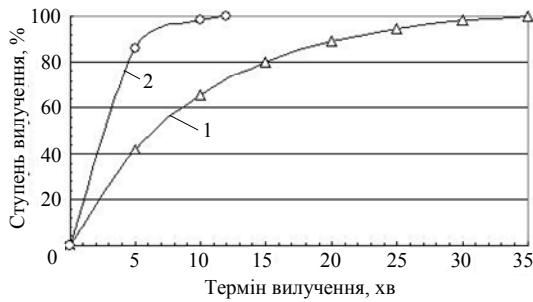
Рис. 1. Залежність ступеня вилучення феруму від терміну контактування відпрацьованого сплаву ВНЖ-90: з нітратною кислотою (1), з нітратною кислотою у присутності озону (2)
