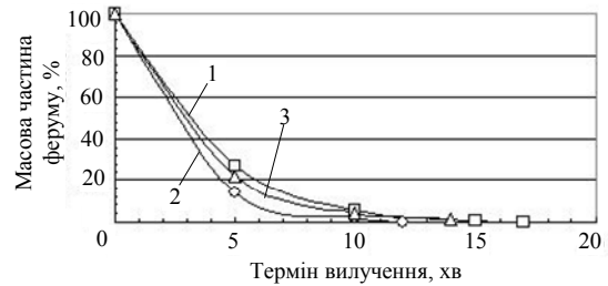
Рис. 2. Вміст феруму у сплаві ВНЖ-90 в залежності від терміну його обробки: 291 К (1), 301 К (2), 311 К (3)
