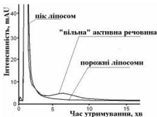
Рис. 38. Хроматограмма липосомальной формы доксорубицина гидрохлорида и хроматограмма пустых липосом (СФ-детектор)
