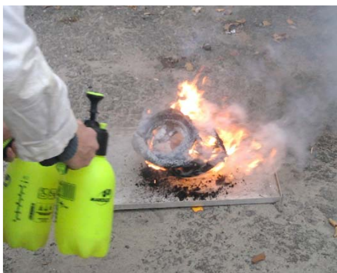
Рис.2. Тушение лабораторного модельного очага ПОС ( \text{NH}_4\text{H}_2\text{PO}_4 + \text{NaHCO}_3 + \text{пенообразователь «Морской»-6\% )
