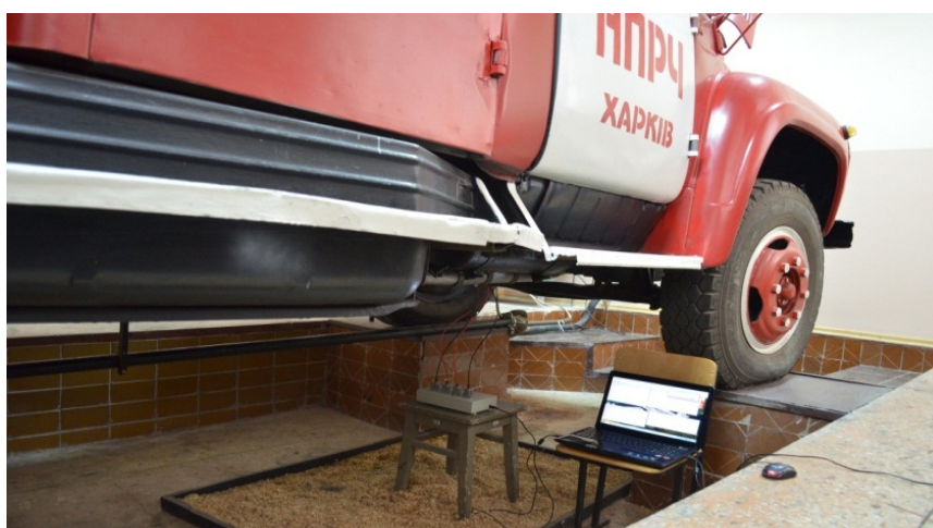
Рис. 3. Визначення температури вихлопної труби пожежного автомобіля марки АЦ-40(130)63Б, що є нерухомим, а ДВЗ працює під навантаженням (на пожежний насос)
