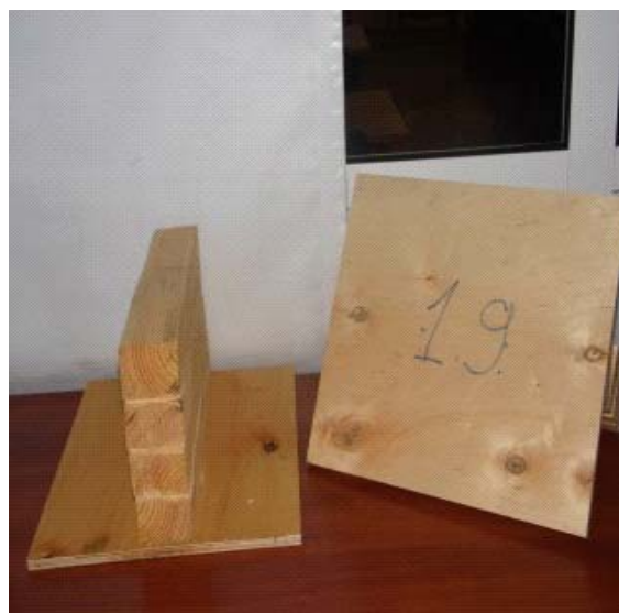
Рис. 1. Фрагмент дерев'яної балки для випробування з розміщенням термопар
