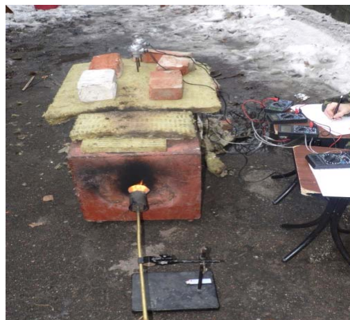
Рис. 2. Установка для проведення вогневих випробувань
