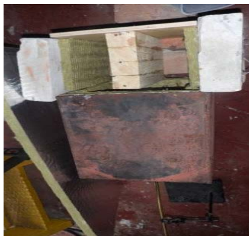
Рис. 2. Установка для проведення вогневих випробувань
