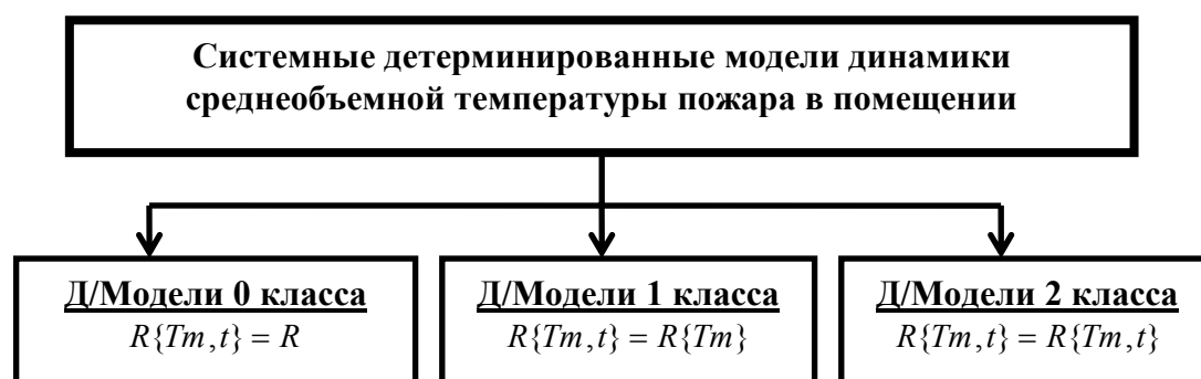
Рис. 1. Системная классификация детерминированных моделей динамики среднеобъемной температуры при пожаре в помещении
