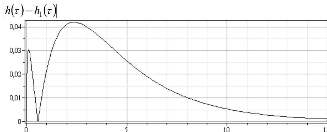
Рис. 5. Погрешность рассогласования между переходными функциями h(\tau) и h_1(\tau)
