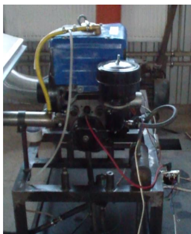
Рис. 6. Загальний вид дослідної установки пожежогасіння періодично-імпульсної дії в роботі
