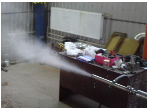
Рис. 6. Загальний вид дослідної установки пожежогасіння періодично-імпульсної дії в роботі
