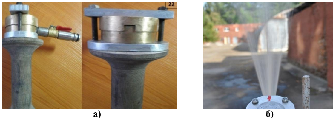
Рис. 3. Ствол-розпилювач СР-10: а) фото загального вигляду; б) подача струменю на відкритому просторі
