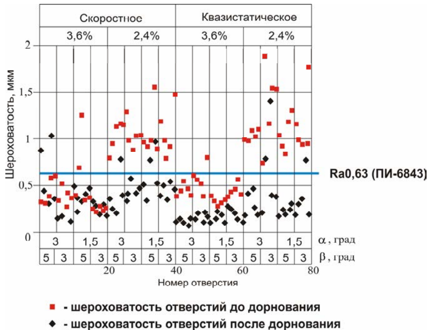
Рисунок 5 – Шероховатость отверстий до и после квазистатического и скоростного дорнования
