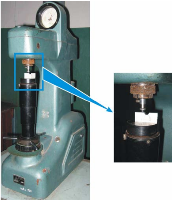
Рисунок 8 – Устройство для измерения твердости ТК-2
