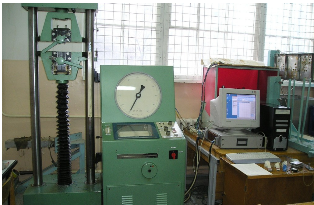
Рисунок 4 – Испытательная машина с электронной системой записи и построения диаграммы сила – деформация
