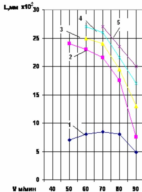
Рисунок 11 – Зависимость длины пути резания от скорости. Инструментальный материал: 1 – BK6 с покрытием: 2 –  $Mo_2N$ ; 3 – TiN; 4 – 0,5TiN+0,5AlN; 5 – 0,2HfN+0,8AlN (38XC).
