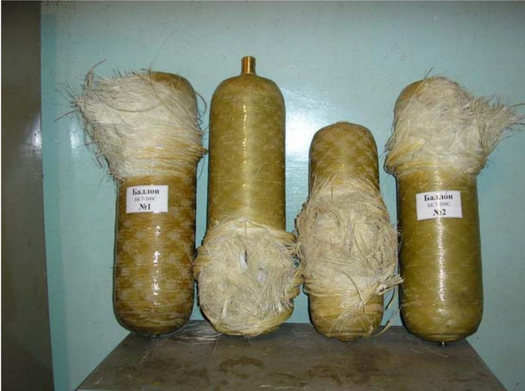
Рисунок 1 - Характер разрушения баллонов
