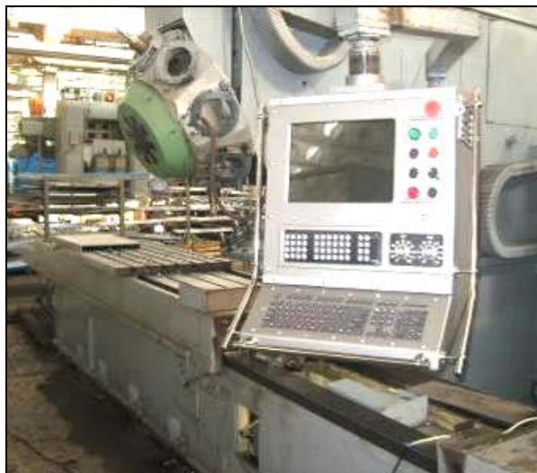
Рисунок 1 – Станок ФП-7СМН5 после модернизации с системой ЧПУ АВІ.04
