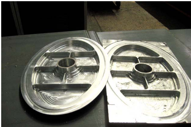
Рисунок 8 – Крышка люка, изготовленная по исходной УП (слева), и эта же деталь перед финишными операциями по ускоренной УП (справа)
