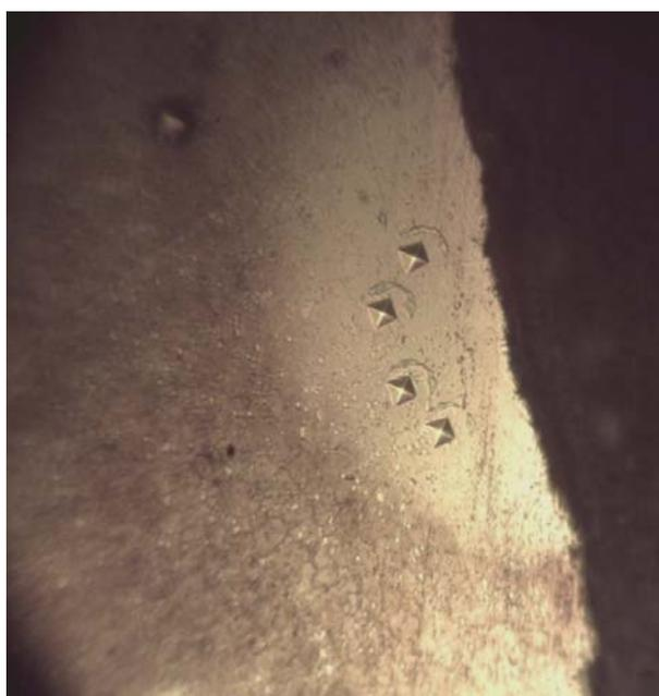
Рисунок 3 – Структура зоны лазерной многоимпульсной обработки в образцах из стали P6M5, длительность импульса – 60 мкс
