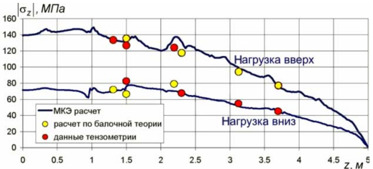
Рисунок 3 – Распределение нормальных напряжений по нижнему поясу заднего лонжерона
