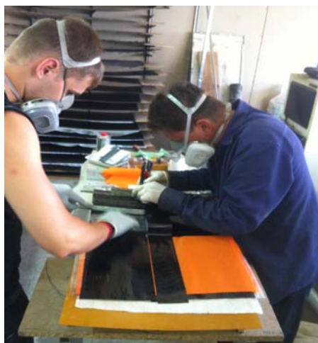
Рисунок 11 – Укладка и раскрой препрега
