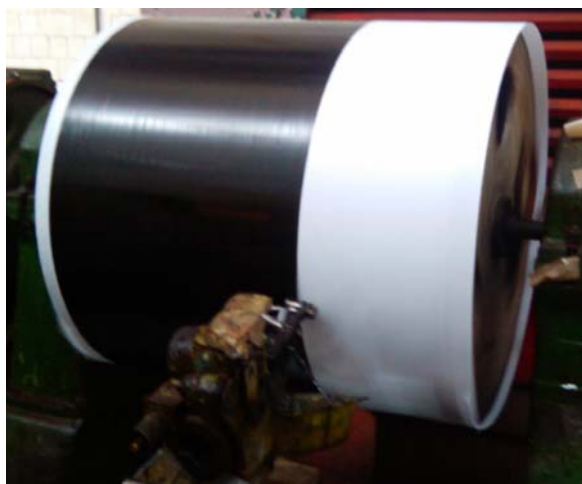
Рисунок 2 – Изготовление препрега путем намотки углеродной ленты на цилиндрическую оправку
