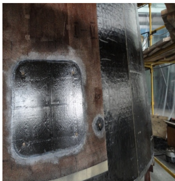
Рисунок 8 – Выкладка слоев наружной обшивки МСО
