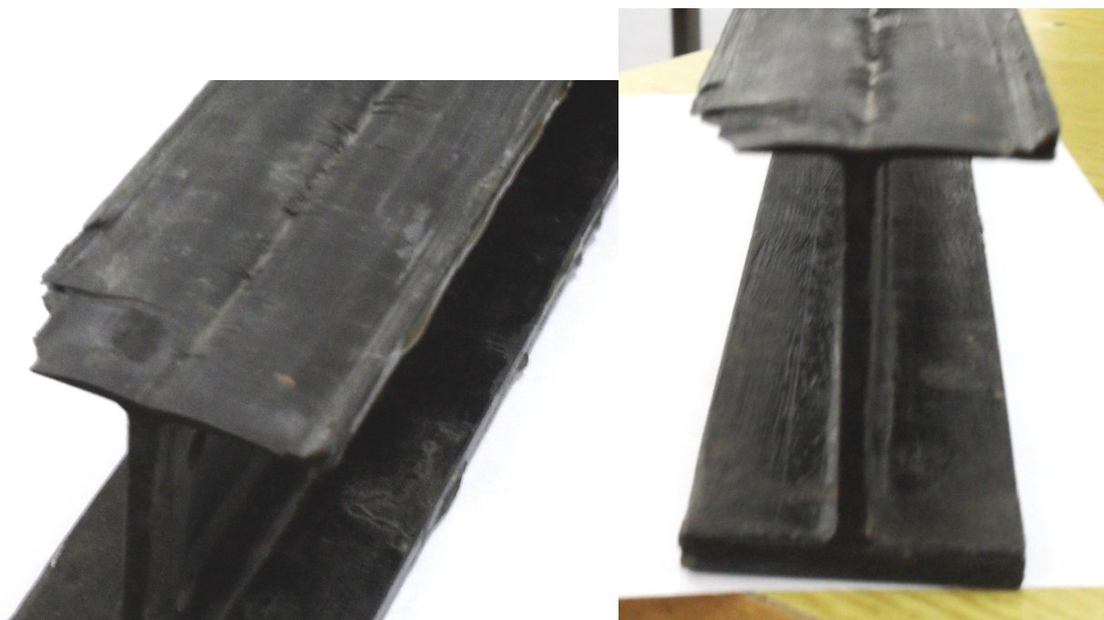
Рисунок 5 – Разрушение соединения полки со стенкой образца № 3
