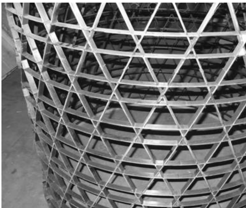
Рисунок 1 – Типовая сетчатая конструкция, состоящая из спиральных и кольцевых ребер
