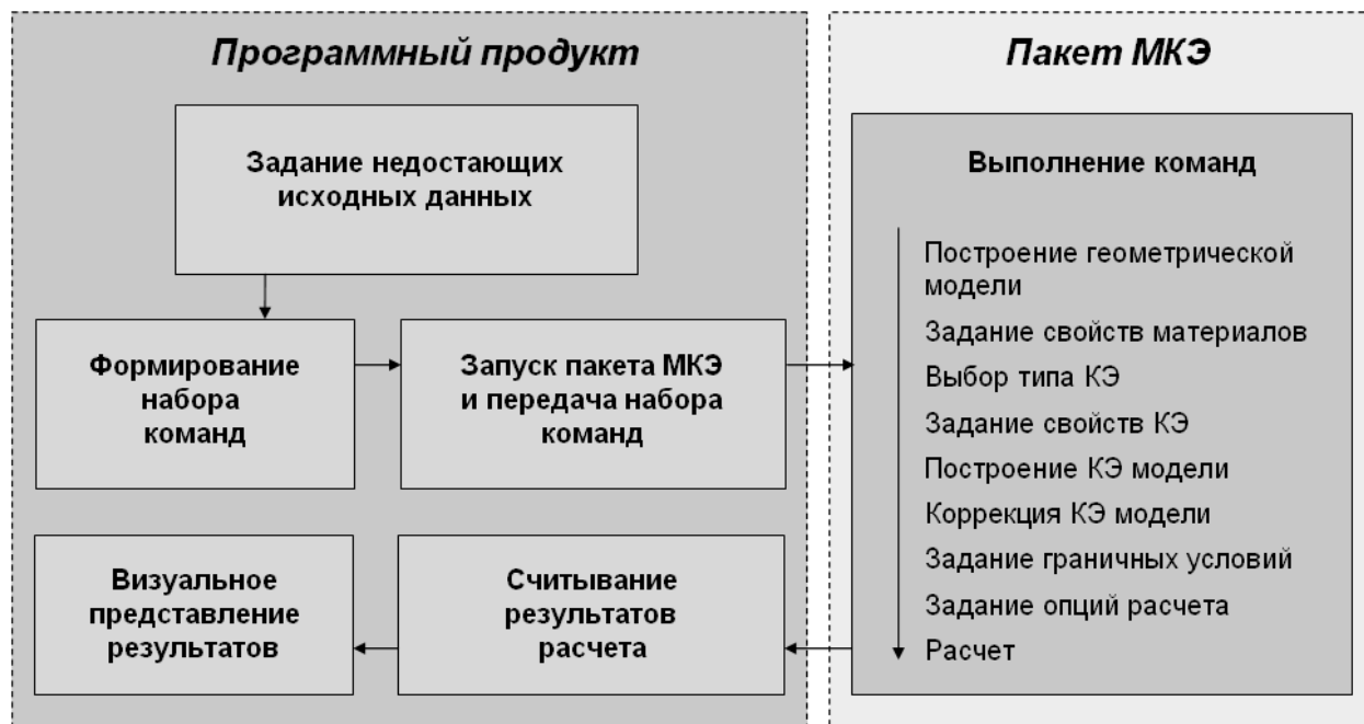
Рисунок 10 – Схема двустороннего обмена данными между разработанным ПП и программным комплексом конечно-элементного анализа
