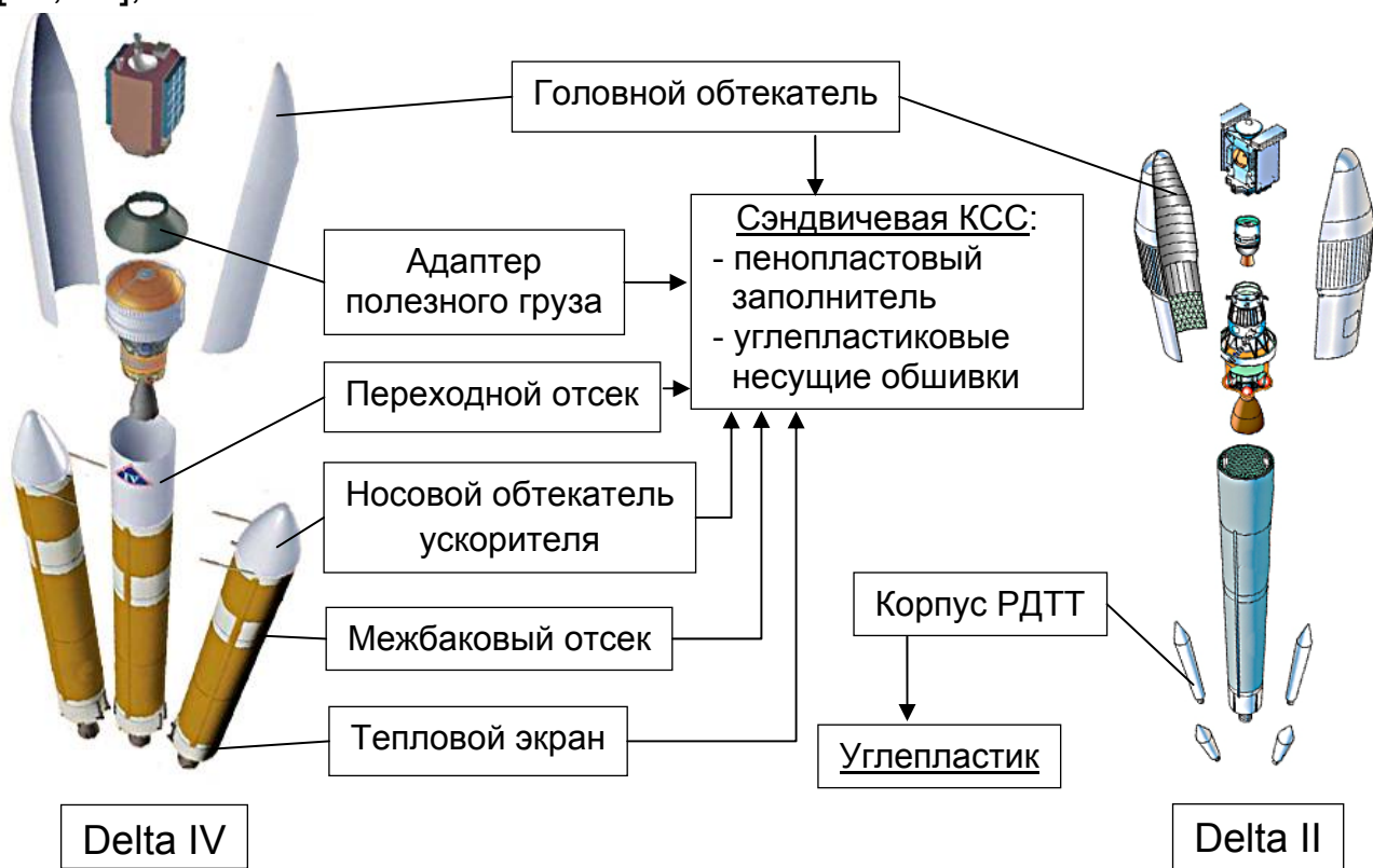
Рисунок 3 – Номенклатура типовых композитных агрегатов РКН «Delta II» и «Delta IV»
