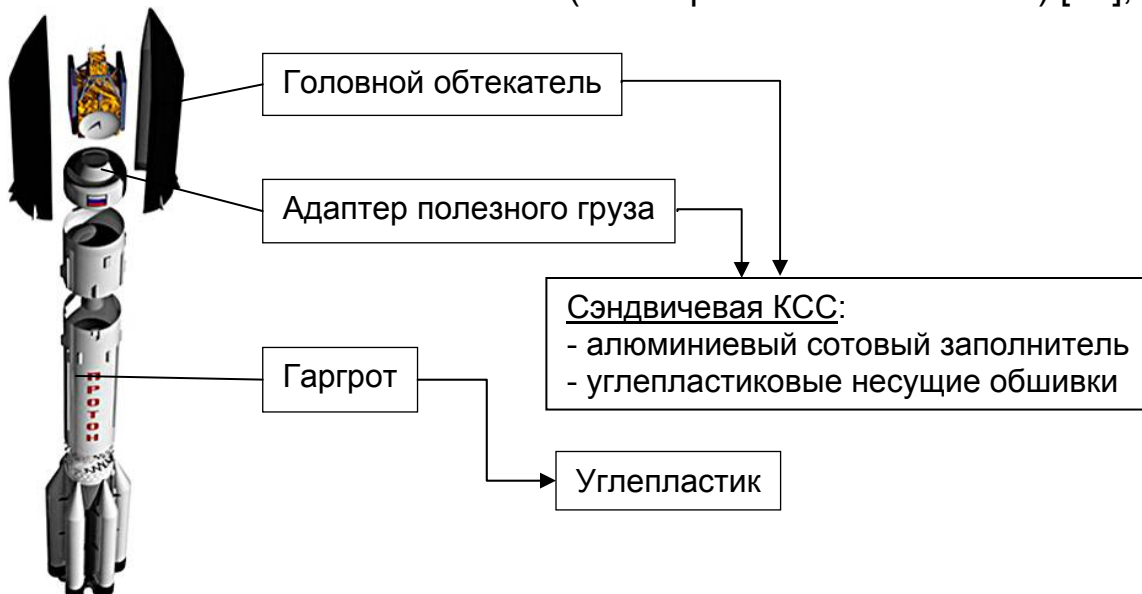
Рисунок 1 – Номенклатура типовых композитных агрегатов РКН «Протон-М»
