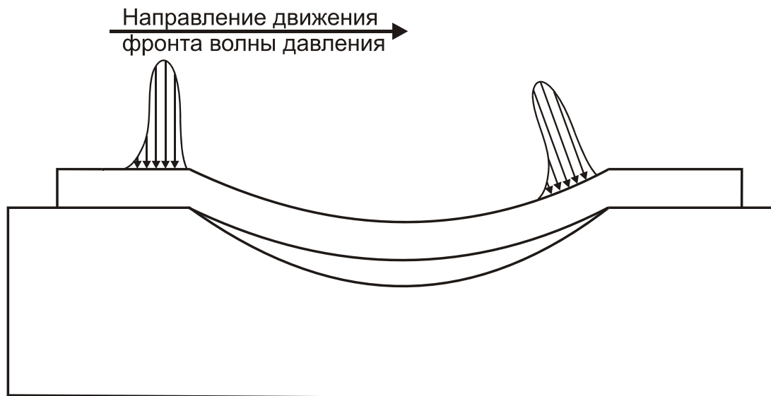
Рисунок 2 – Схема движения и форма фронта волны давления при импульсном формообразовании
