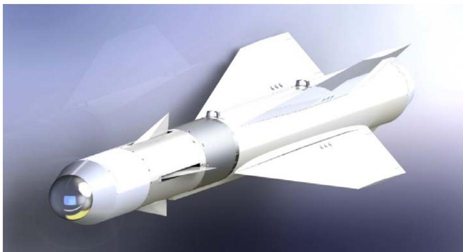
Рисунок 1 – ЛА с выдвижным дестабилизатором, выполненный по аэродинамической схеме «бесхвостка»
