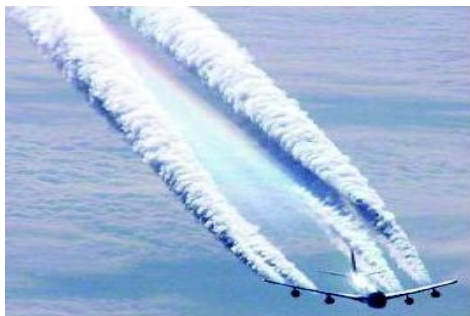
Рисунок 2 – Визуализация вихревых структур за B-727
