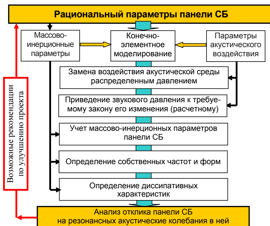
Рисунок 8 – Блок-схема алгоритма поверочного расчета панелей СБ при воздействии звукового давления, основанного на конечно-элементном моделировании возникновения в них резонансных акустических колебаний
