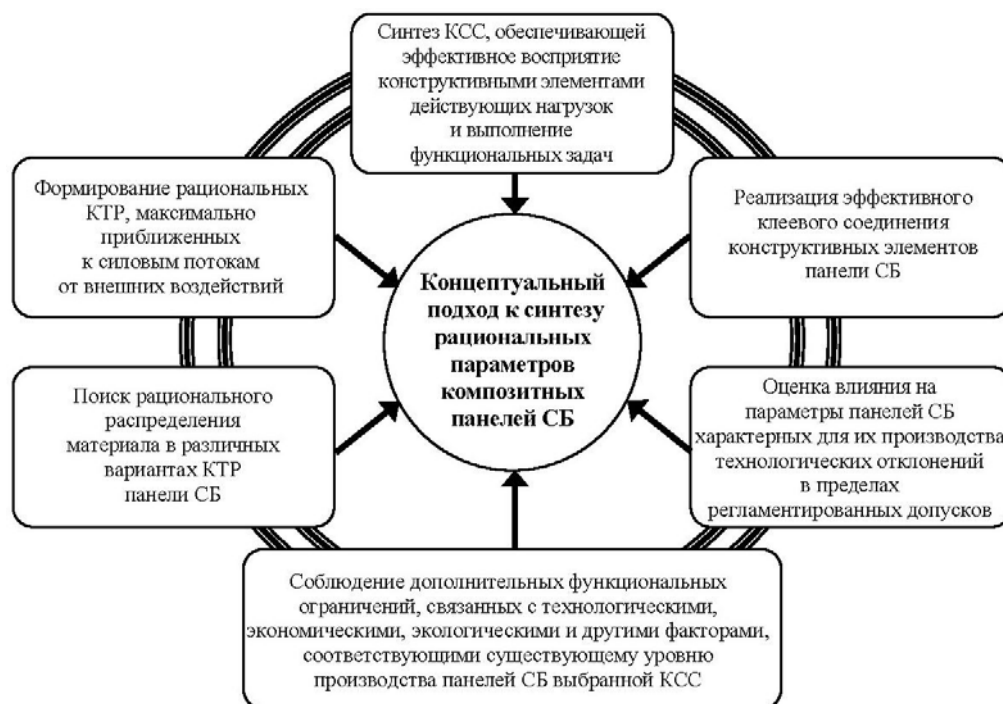
Рисунок 1 – Комплексная реализация принципов концептуального подхода к синтезу рациональных параметров панелей СБ космического назначения
