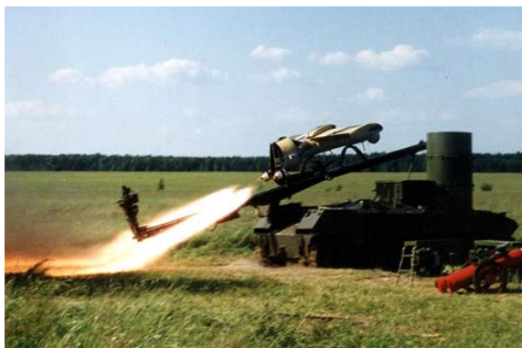
Рисунок 2 – Примеры пиротехнического старта БЛА с поверхности и соответствующие им конфигурации шашек ТРТ (бронированная поверхность указана толстой линией): а – газодинамический «Sea Sparrow AIM-7»; б – минометный «С-300»; в – с помощью стартового ускорителя «Hunter»; г – с помощью стартовой тележки «Пчела-1»
