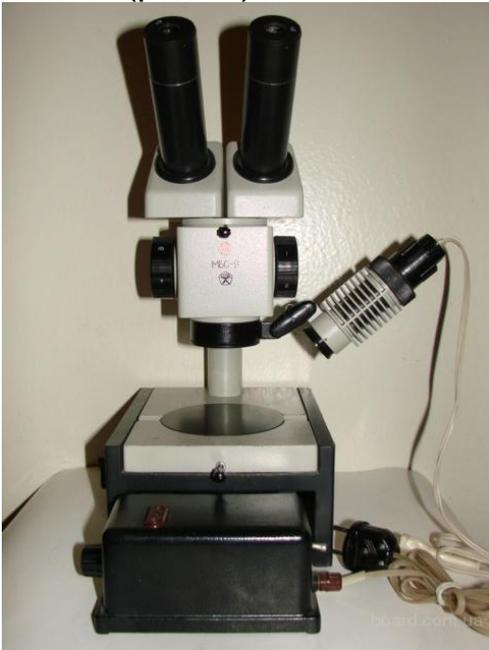
Рисунок 2 – Микроскоп МБС-9
